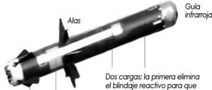
Dos cargas: la primera elimina el blindaje reactivo para que la segunda pueda impactar contra la armadura principal
